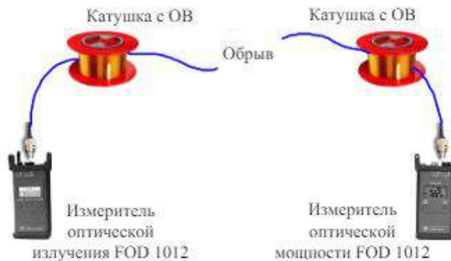
Рисунок 30 - Схема внесения обрыва
