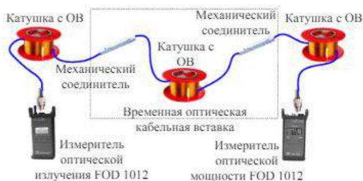
Рисунок 31 - Схема монтажа ВОКВ при АВР на ВОЛП
