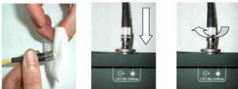
Рисунок 29 - Подключение ОВ к источнику оптического излучения
