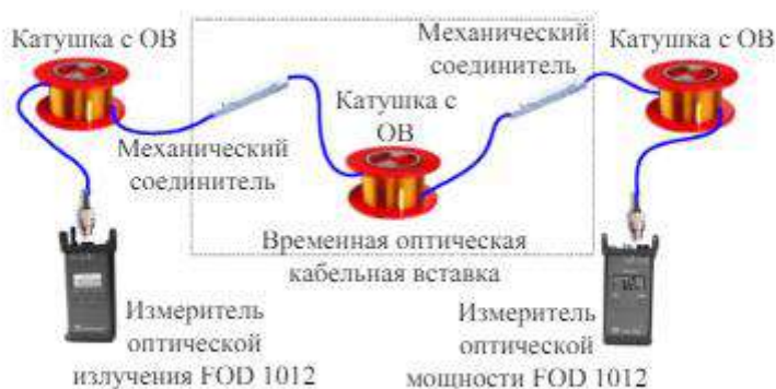
Рисунок 31 - Схема монтажа ВОКВ при АВР на ВОЛП
