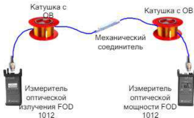
Рисунок 28 - Схема измерения потерь на ВОЛП без повреждений
