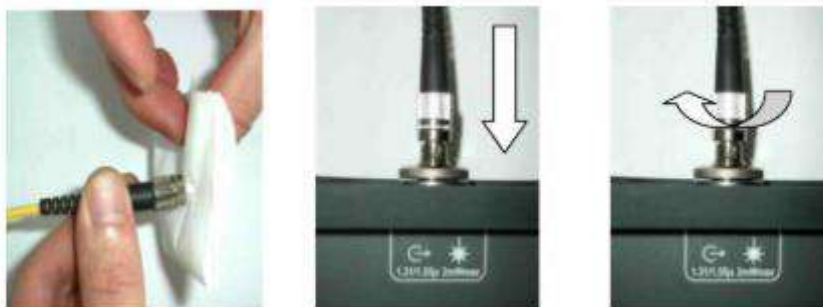
Рисунок 29 - Подключение ОВ к источнику оптического излучения
